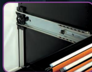
Glissières à billes à extraction totale. Système d'ouverture sélective en standard, interdisant l'ouverture simultanée de 2 cadres coulissants. Charge 50 kg par cadre.
