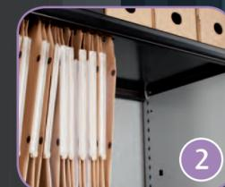
Tablettes pour dossiers suspendus et classement à plat. La conception des tablettes à triples plis nervurés longitudinaux avant et arrière permet de recevoir une charge de 80 kg uniformément répartie. Prof. 360 mm prévue pour recevoir des dossiers suspendus, entraxe 330 mm. Réglage au pas de 25 mm par taquets en acier sur doublures profilées.
